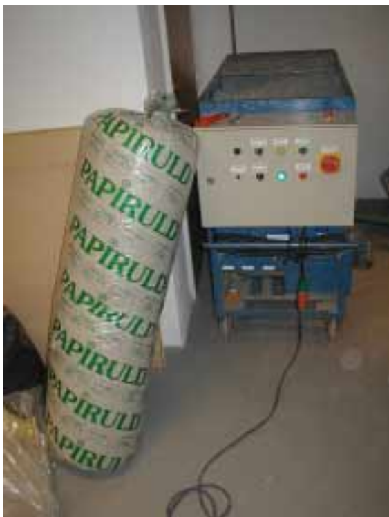
Figur 3.10. Celluloseuld som løsfyld i emballage fra fabrikken samt indblæsningsudstyr
