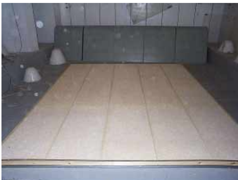
Figur 4.5. Færdiggjort absorpent med træbetonplader
